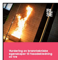
RISE Fire Research AS, Rapport 2021:61 Vurdering av branntekniske egenskaper til fasadekledning av tre - Branntesting av trekledning med ulike typer behandling
