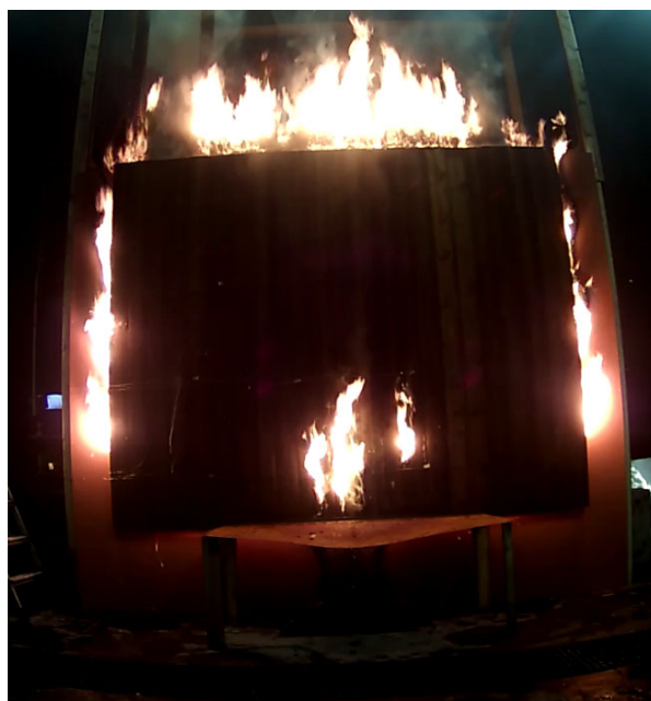
Figur 4-13: Forsøk E4 F-R med brannklasse F som vindsperre og royaloljebehandla furu som kledning 16 minutt etter tenning. Her har brannen spreidd seg heilt ned på begge sidene, i tillegg til at det har brent gjennom kledninga. Startbrannen var i gjennomsnitt 41 kW i 714 sekund.
