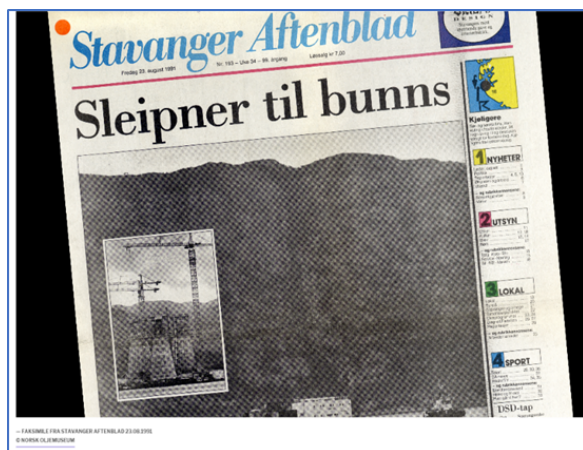
Figur 4: 3. august 1991 gikk Sleipner-plattformen til bunns i Gandsfjorden. Allerede samme dag kunne representanter fra Norwegian Contractor (NC) orientere om at ulykken sannsynligvis skyldtes en underdimensjonering trekantceller ved feil bruk av et dataprogram hos Olav Olsen. Den samme feilen var blitt gjort på Draugen! Kvalitetssikringen hadde feil fokus, og det var ikke vanskelig å finne feilen i ettertid.
